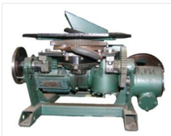
Сварочное оборудование предназначено для установки в положение, удобное для сварки и вращения изделий со сварочной скоростью при автоматической, полуавтоматической и ручной электродуговой сварке, а также может использоваться при наплавочных работах. Может использоваться в сварочном производстве машиностроительных отраслей промышленности, строительства, на ремонтных работах. Управление от ножной педали.
