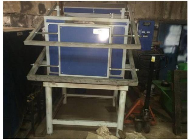
Фото 32. Печь электрическая сопротивления 400\*800\*400 мм
