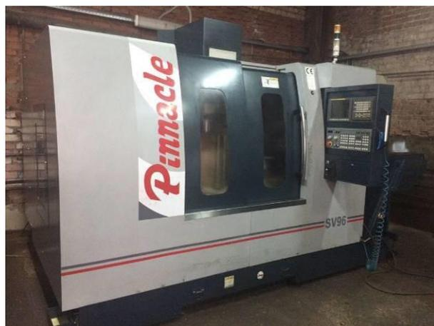
Фото 30. Вертикальный фрезерный обрабатывающий центр Pinnacle, модель SV-96
