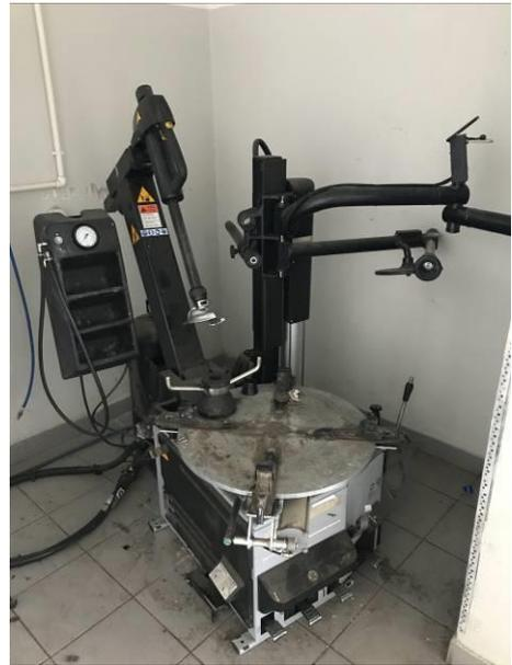
Фото 20. Шиномонтажный станок Hunter
