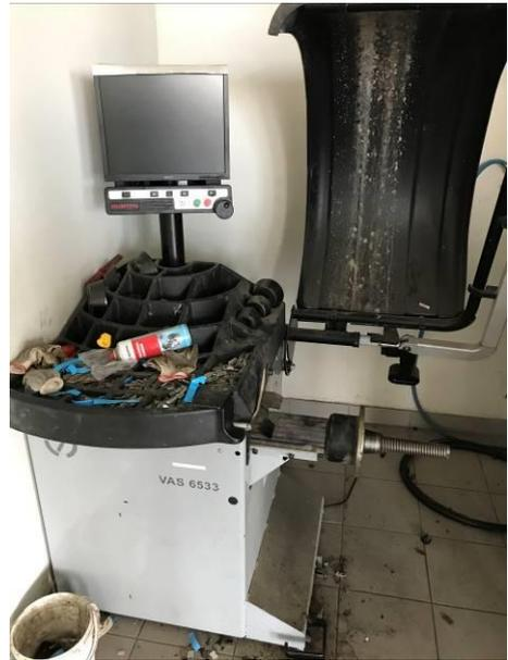
Фото 14. Балансировочный станок Hunter
