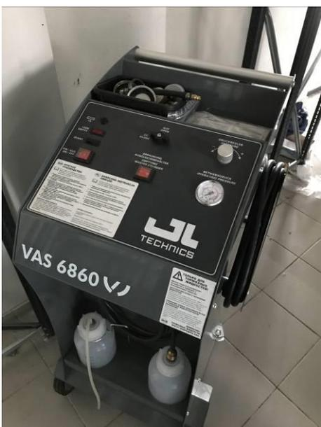
Фото 3. ASE42401300000, 6860, Устройство для заправки и прокачки тормозной системы
